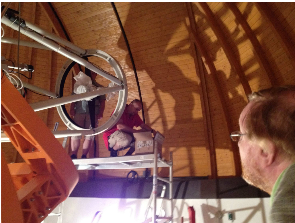
Instalace nové CCD kamery na teleskop KLENOT
